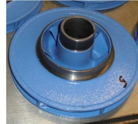
Laufblätter beschichtet und überdreht zur Spaltmaß Korrektur
