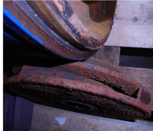
Laufblad mit Blasenbildung, Grauguss fängt zum „blühen“ an
