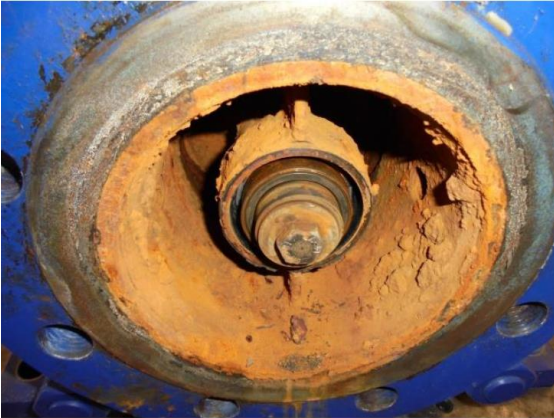
Sauggehäuse mit Ablagerungen
